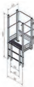
Salida con gradilla, barandilla y puerta
