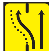
TS-61 Desvío de un carril por la calzada opuesta, manteniendo otro por la de obras
