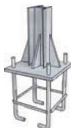
Cimentación placa anclaje
