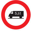
R-107 Entrada prohibida a vehículos destinados al transporte de mercancías con mayor peso autorizado que el indicado
