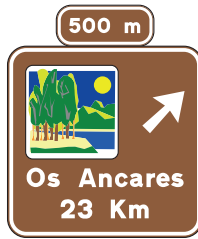
Preseñalización de salida en carretera convencional
