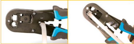
Corte de cables de red
